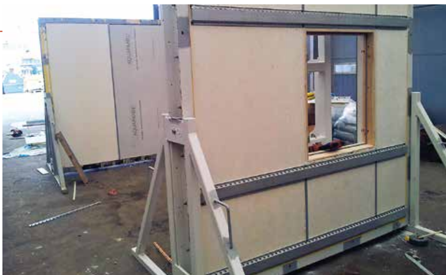
Limmade ytterväggar slagregnstestas med tätt resultat.
