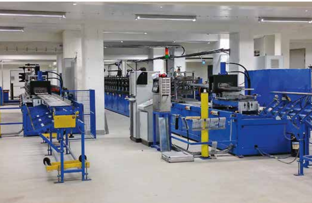
Produktionsutrustning bestående av 2 st rullformningsmaskiner, en för CBZ-profilen och en för CBC, CBU och CBUI.
