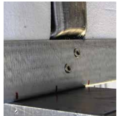
Figur 6 Brott i infästning av väggregel i skena vid prov.
